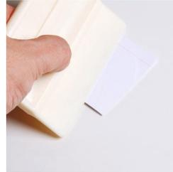
Umdrehen, und die eingeschlossene Luft von innen nach aussen rakeln.
