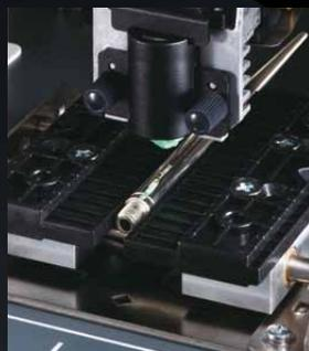
\* Die Vickers-Härte des Materials darf nicht größer als 200 sein. Einige Formen können nicht bedruckt werden. Es wird empfohlen, das Material zuerst zu testen.
